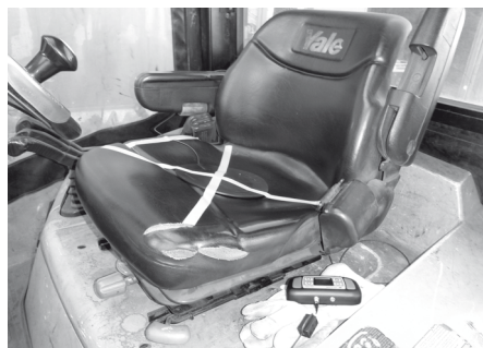
Obr. 2: Měření vibrací celého těla
