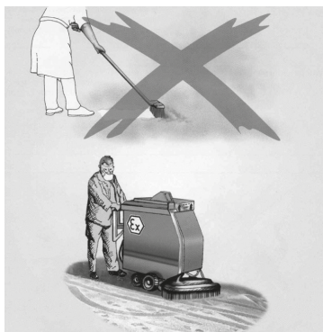
Obr. 3: Nevhodný a vhodný způsob odstranění hořlavého prachu
